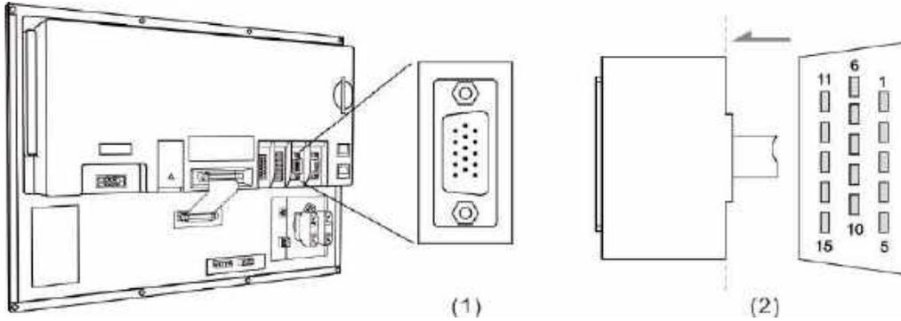
(1) Spindle feedback input pins (female); (2) Spindle feedback input pins (male)
